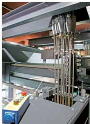
Seil-Widerlager für beengte Einbauverhältnisse
